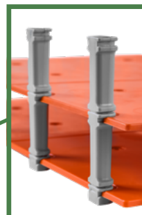
Sistema de suporte em até três níveis , presos por encaixe. Altura regulável conforme a necessidade e tamanho dos componentes.
